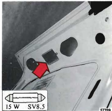
Rimuovere la plafoniera
