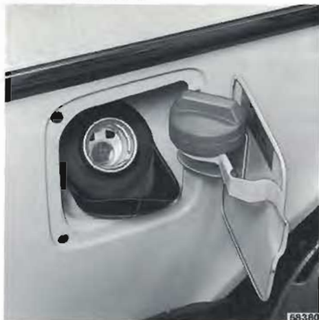
Bocchettone rastremato, sulle vetture con marmitta catalitica
