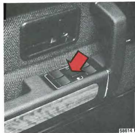
Bloccaggio alzacristalli posteriori
