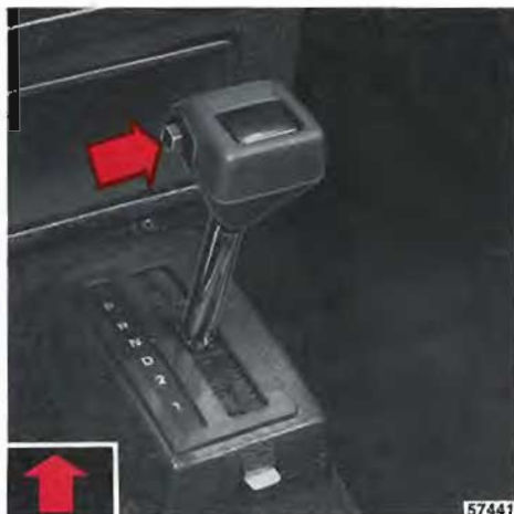
Interruttore a spia per disinserimento/inserimento del 4.o rapporto
