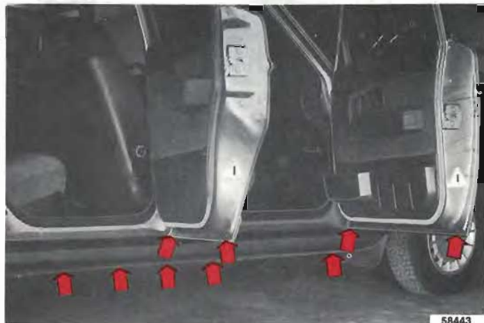
Fori di drenaggio
