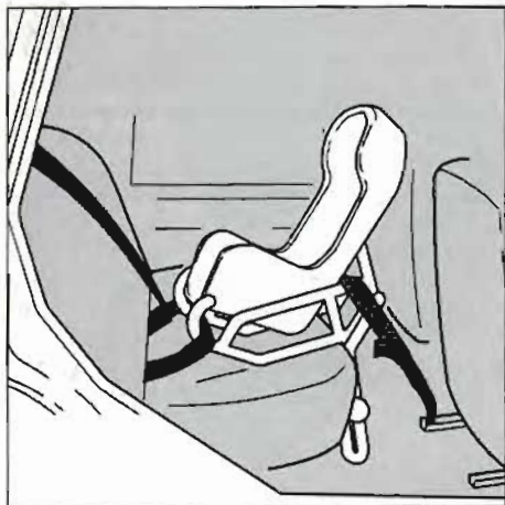
Montaggio sul posto centrale del divano
