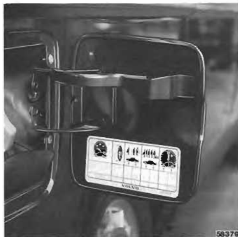
All'interno dello sportellino del serbatoio è applicata una targhetta specifica, riportante la corretta pressione di gonfiaggio dei pneumatici
