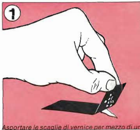
Asportare le scaglie di vernice per mezzo di un nastro adesivo
