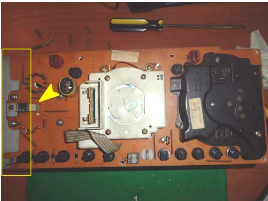
*Ora svitate le 4 viti indicate dalle frecce gialle. Il contachilometri adesso è libero. Spingete delicatamente il pezzo di bachelite indicato dalla freccia verde e lo strumento uscirà dal proprio alloggiamento.*
